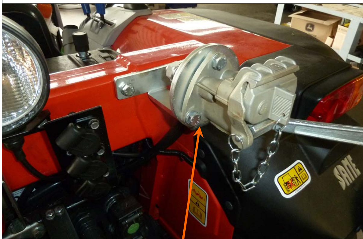
GIUNTO CUNA OPPURE ISO GIALLO/ROSSO/NERO PER COLLEGA- MENTO AL RIMORCHIO JOINT CUNA ISO OR YELLOW / RED / BLACK FOR CONNECTION TO THE TRAILER
