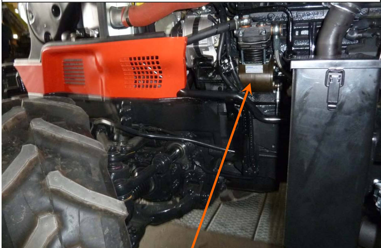
COMPRESSORE POSIZIONATO ALL'INTERNO DEL COFANO MOTORE COMPRESSOR PLACED INSIDE THE ENGINE BONNET
